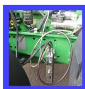
Il permet de connaître la consommation horaire du tracteur en fonction de son régime moteur. Cet outil s'installe en série sur le circuit de carburant du tracteur. Ainsi, il compare la quantité de carburant qui arrive au moteur et la quantité de carburant qui repart au réservoir.
