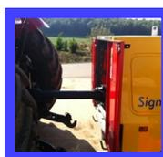
C'est un frein magnétique permettant de mesurer le couple moteur. Il est relié au tracteur par un cardan branché à la prise de force arrière du tracteur. Un champ magnétique crée une force résistante dans le but d'augmenter la charge du moteur du tracteur.
