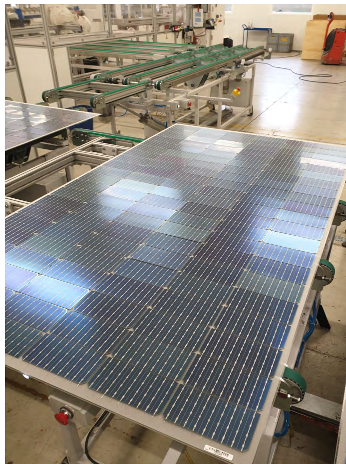
Montage de panneaux projet Voltec 2023
