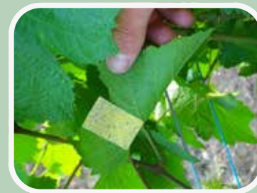
Contrôle de la taille et de la répartition des gouttelettes avec des papiers hydrosensibles.
