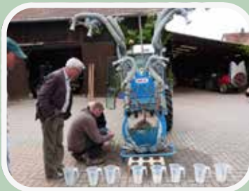
Contrôle du débit des buses.
